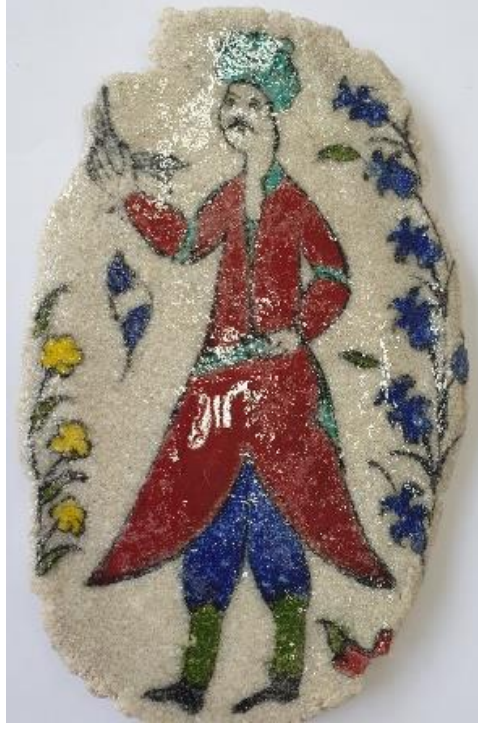
Resim 28: Sır tabakasının ince ve eşit olmayacak şekilde kullanılması ya da firitle çamurlarda olduğu gibi gözenek yapısının fazla olması nedeniyle hamurun sırrı emmesi sonucu meydana gelen yüzeysel kellik-mat görünüş.
