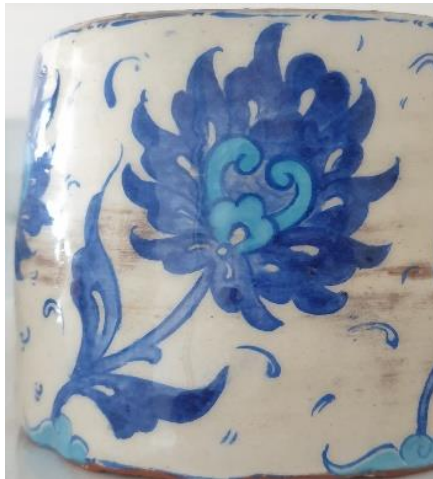
Resim 19: Astar tabakasının yüzeye homojen (eşit dağılımlı) sürülmemesi sonucu meydana gelen zemin rengi farklılığı
