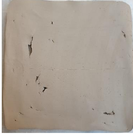
Resim 7: Plaka olarak şekillendirilen çini çamurunda bulunan hava boşlukları
