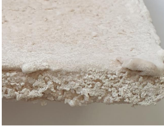
Resim 3: Çini karoda kullanılan malzemeye bağlı meydana gelen sodalama ve sır yırtılması
