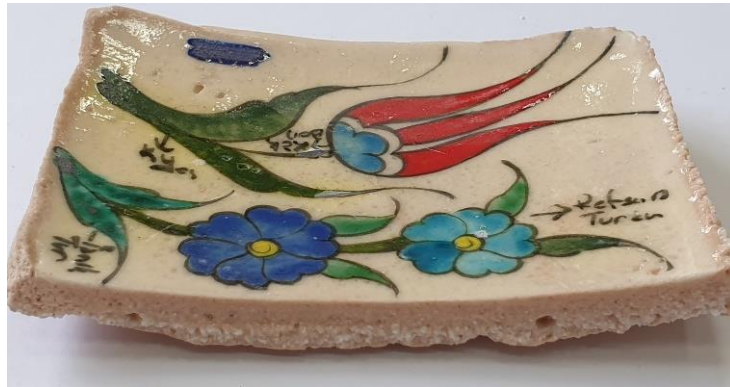
Resim 9: Plaka olarak şekillendirilen çini çamurunda kurutma esnasında meydana gelen eğilme-deformasyon.
