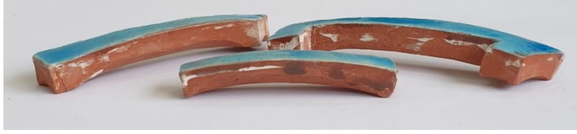
Resim 10: Plaka olarak şekillendirilen çini çamurunda hızlı pişirim (ani ısı artışı) esnasında meydana gelen eğilme-deformasyon.
