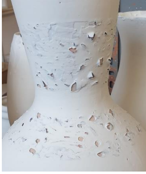
Resim 24: Sır tabakasının ve boyanın kalın uygulanması sonucu sırlama aşamasında meydana gelen sır ve boya dökülmesi
