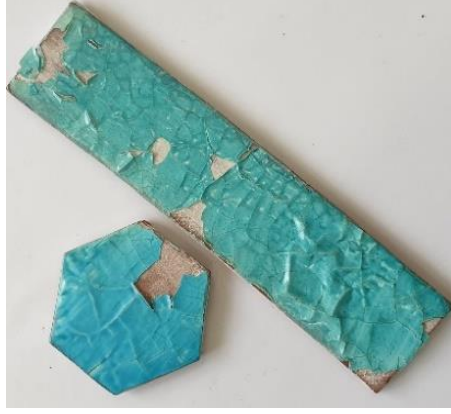
Resim 17: Çini karonun astar, sır uyumsuzluğu sonucu meydana gelen kavlama
