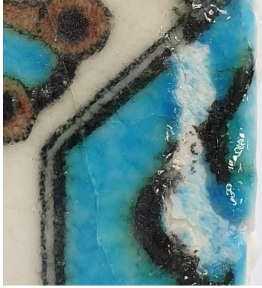
Resim 3: Çini karoda kullanılan malzemeye bağlı meydana gelen sodalama ve sır yırtılması
