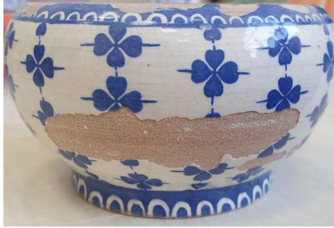
Resim 16: Çini kasede astar ile hamur uyumsuzluğu sonucu meydana gelen astar-sır tabakasının kabuklanarak ayrılması
