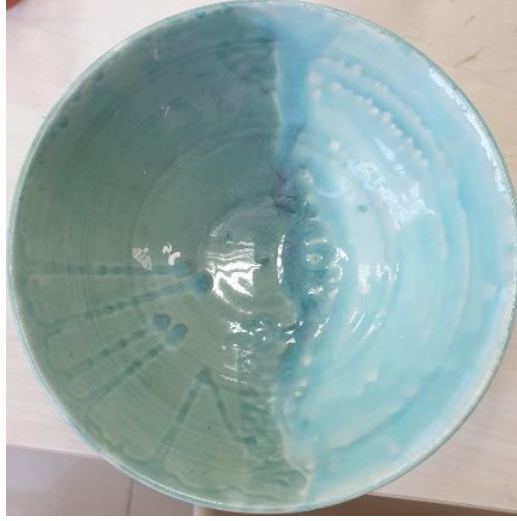
Resim 26: Sır tabakasının dengesiz uygulanması sonucu meydana gelen damlacık lekeleri
