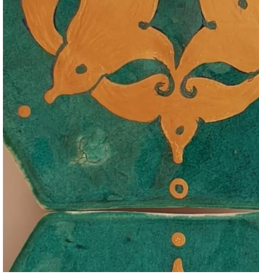
Resim 1: Çini karoda meydana gelen taş atkını (kireç atkını).
