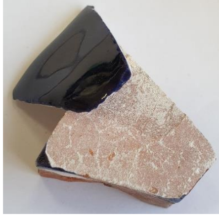
Resim 18: Çini karonun astar, hamur uyumsuzluğu sonucu meydana gelen sır tabakasının ayrılması
