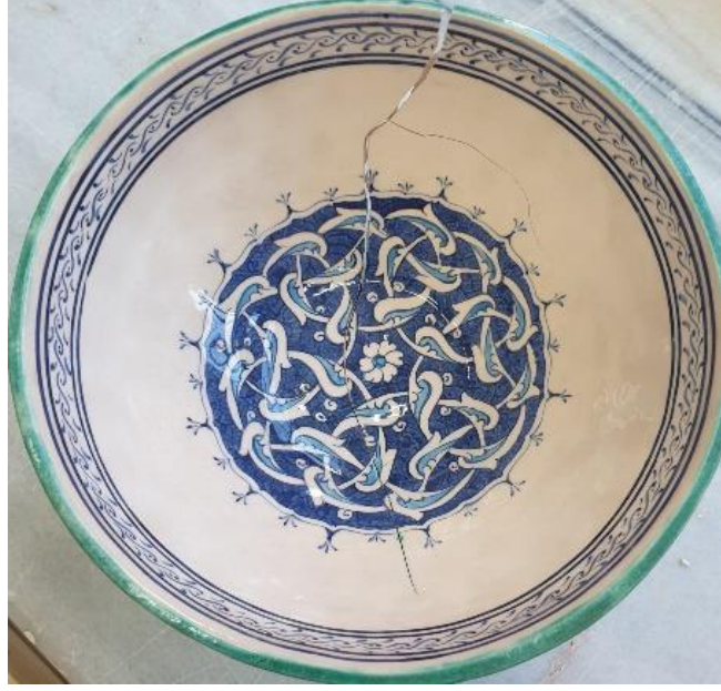
Resim 11: Fırın atmosferinden kaynaklı meydana gelen kırık
