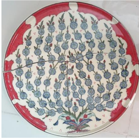
Resim 12: Tam soğumadan fırından çıkarılan tabakta meydana gelen kırık
