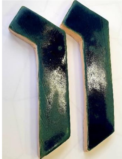
Resim 29: Sır tabakasının ince ve eşit olmayacak şekilde kullanılması sonucu meydana gelen yüzeysel kellik-mat görünüş.
