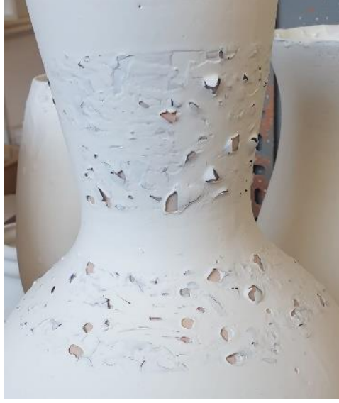
Resim 24: Sır tabakasının ve boyanın kalın uygulanması sonucu sırlama aşamasında meydana gelen sır ve boya dökülmesi
