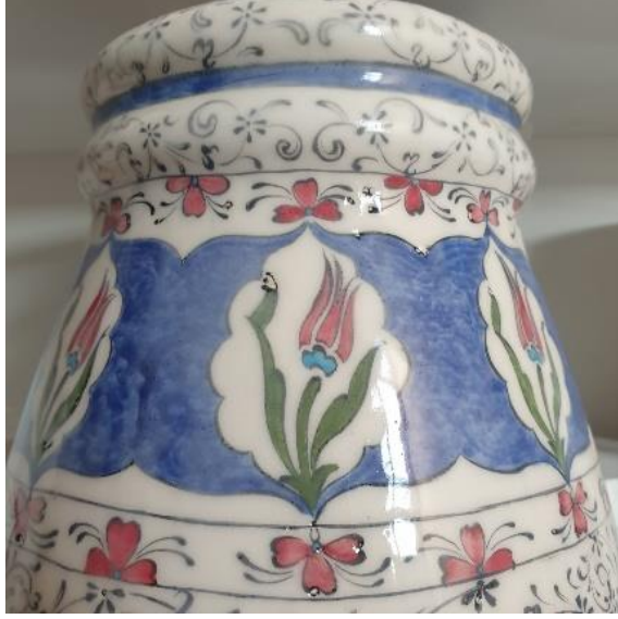
Resim 21: Sır tabakasının kalın uygulanmasından kaynaklı buğulu görünüm.
