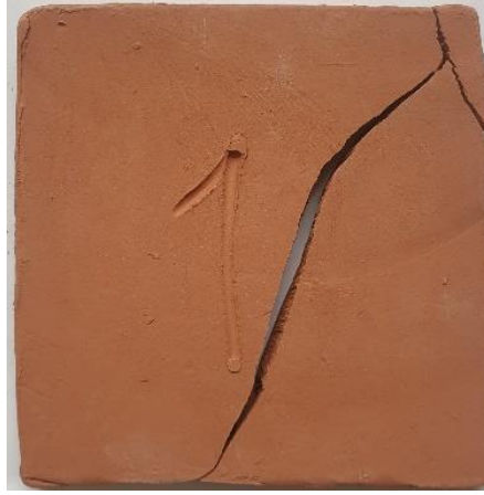
Resim 8: Plaka olarak şekillendirilen çini çamurunda hızlı kurutma esnasında meydana gelen kırık
