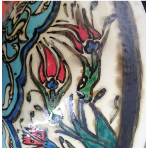
Resim 27: Boyaların kalın kullanılması ve sırrın gelişme derecesinden daha yüksek ısıda pişirim sonucu renklerde meydana gelen dağılma.
